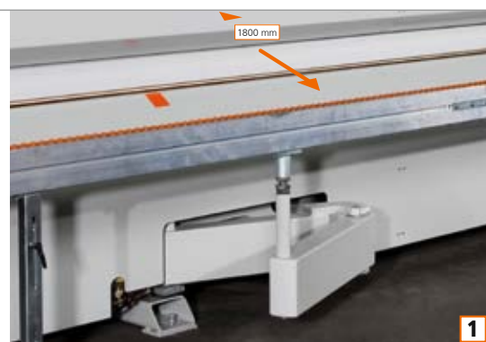
Commande automatique de la quantité de colle
